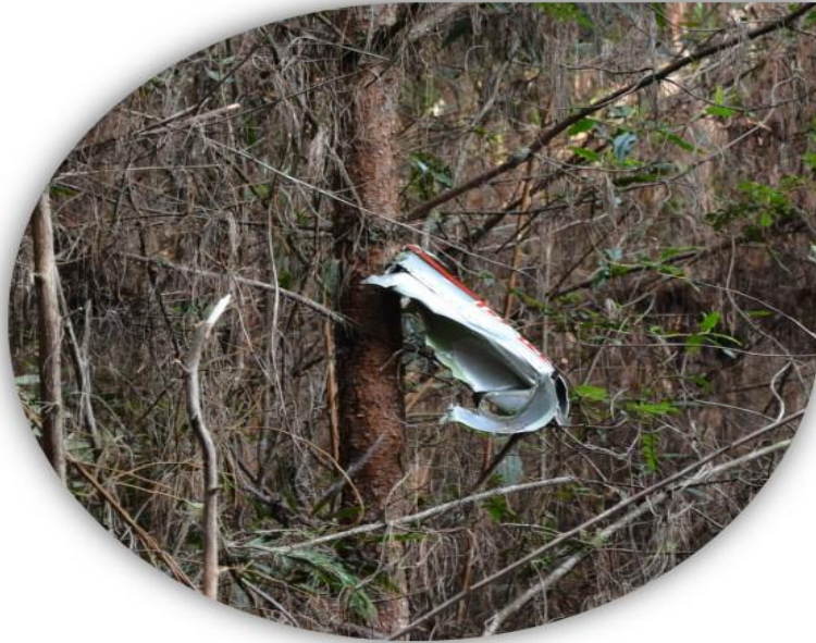
Fotografía No. 7: Restos del tail boom
