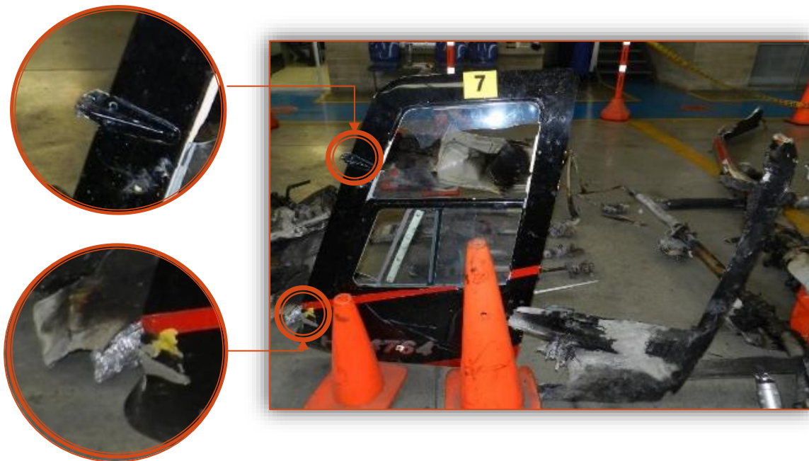
Fotografía No. 2: Puerta delantera izquierda: Evidencias de fracturas en ambas bisagras y rotura en el plexiglás superior con deformación de adentro hacia afuera.
