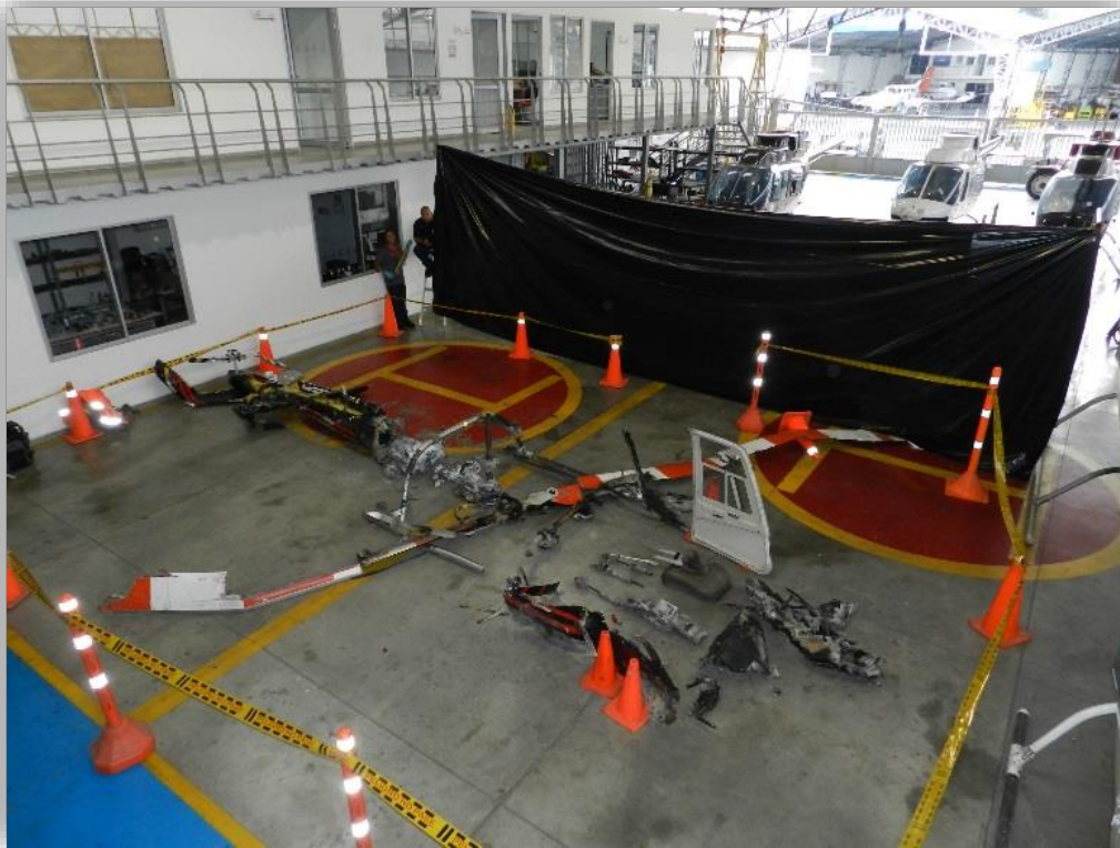
Fotografía No. 4: Reconstrucción de los restos de la aeronave
