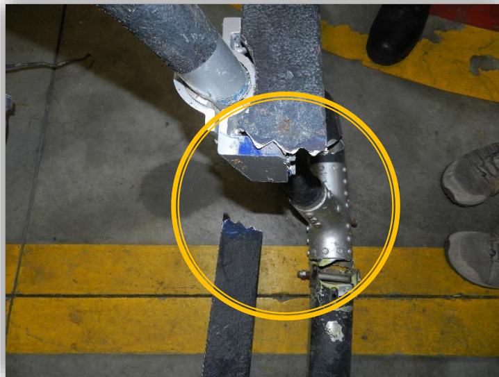
Fotografía No. 8: Fracturas del skid y de la pisadera izquierda
