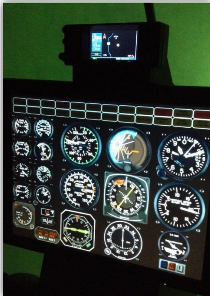
Fotografía No. 3: Recreación en Dispositivo Estático de Entrenamiento de Vuelo
